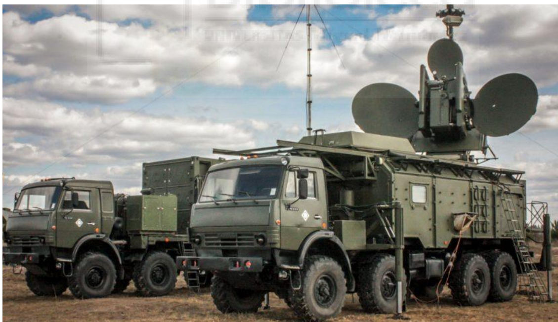
Figura 1. Estación inhibidora móvil rusa Krasukha 4. [1]
