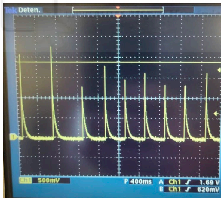
Figura 65. No activación del circuito acondicionador.
