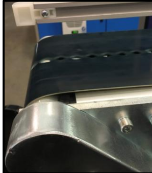
Figura 22. Situación de riesgo de atrapamiento en eje del motor.
