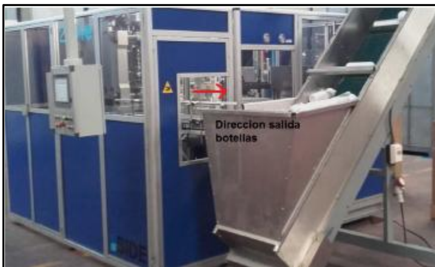
Figura 29. Orientación cinta de salida de envases antes de la modificación.
