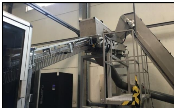
Figura 2. Tolva cargador de preformas
