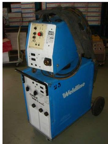
*Ilustración 6. Soldadura eléctrica monohilo*
