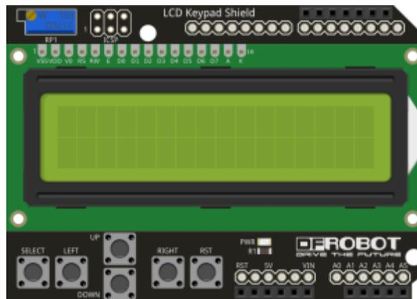
Figura 19. Ejemplo de LCD Keypad Shield [27]
