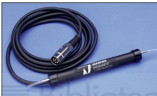
Figura 5. Calentador de perfusión de Warner Instruments [13]
