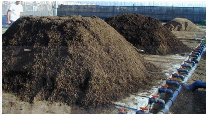
Figura 22: aireación forzada en pilas de compostaje. Fuente: <http://www.compostandociencia.com/2015/02/sistemas-de-compostaje/>
