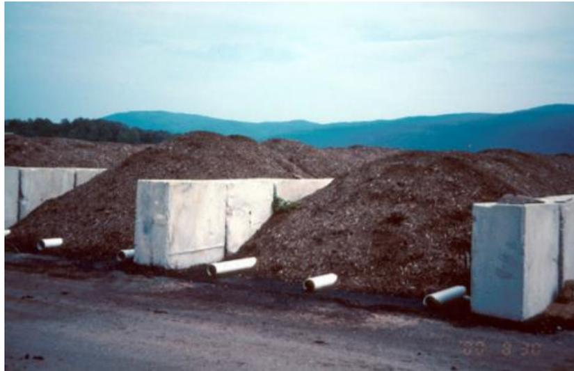
Figura 23: pilas estáticas de compostaje de aireación pasiva. Fuente: Sistemas de Compostaje. Junta de Andalucía.
