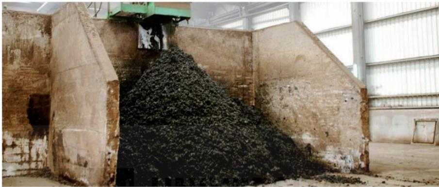
Figura 30: ejemplo de báscula de pesado de un camión de residuos, y almacenamiento de residuos mediante bloques de hormigón bajo previo triturado.
