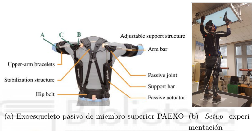
Figura 2.6: Exoesqueleto utilizado y tarea a realizar durante la experimentación desarrollada por P. Maurice et al. Fuente: [11].
