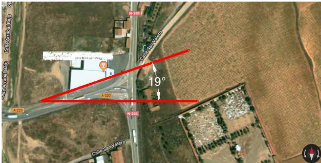
Fig. 34: Estimación del azimut de los captadores, alineados respecto a la fachada con orientación Sureste del edificio de la bodega.
