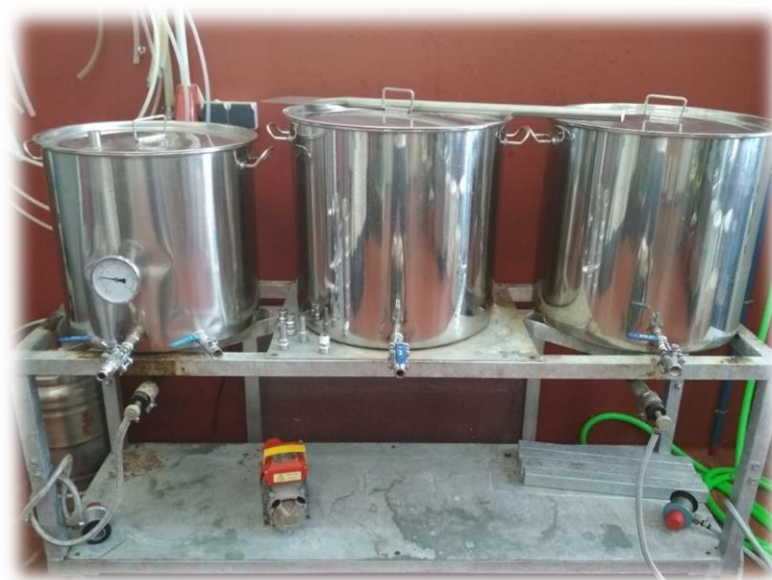
Ilustración 7: Equipo empleado para la elaboración de cerveza
