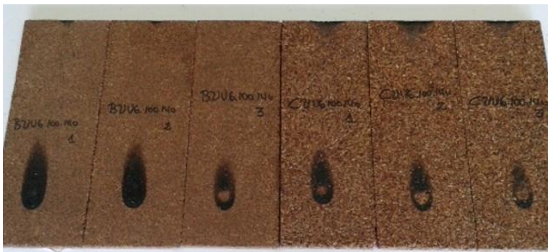
Figura 44. Muestras de paneles de poda de viñedo después del ensayo de inflamabilidad
