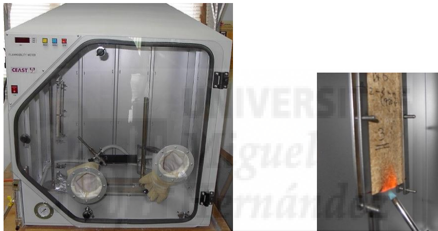
Figura 26. Equipo de inflamabilidad mediante aplicación directa de llama.
