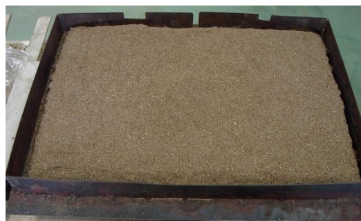
Figura 14. Molde para formar la manta del tablero
