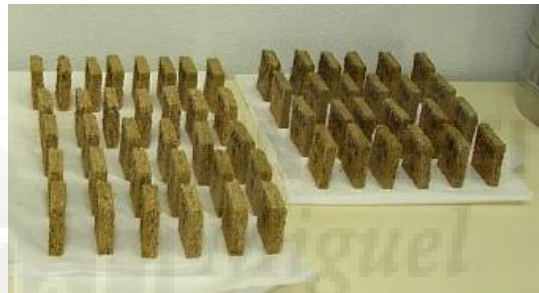
Figura 25. Algunas probetas después de inmersión en agua.
