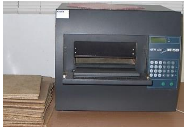
Figura 27. Equipo medidor de flujo de calor.
