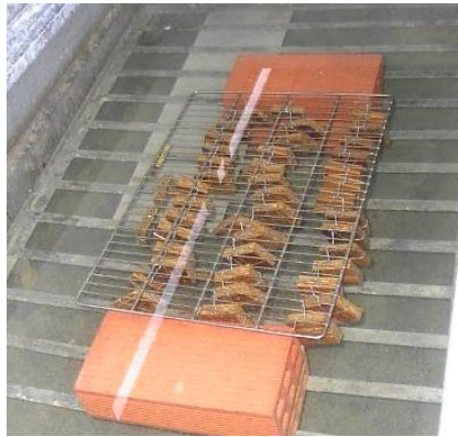
Figura 24. Algunas probetas en inmersión en agua
