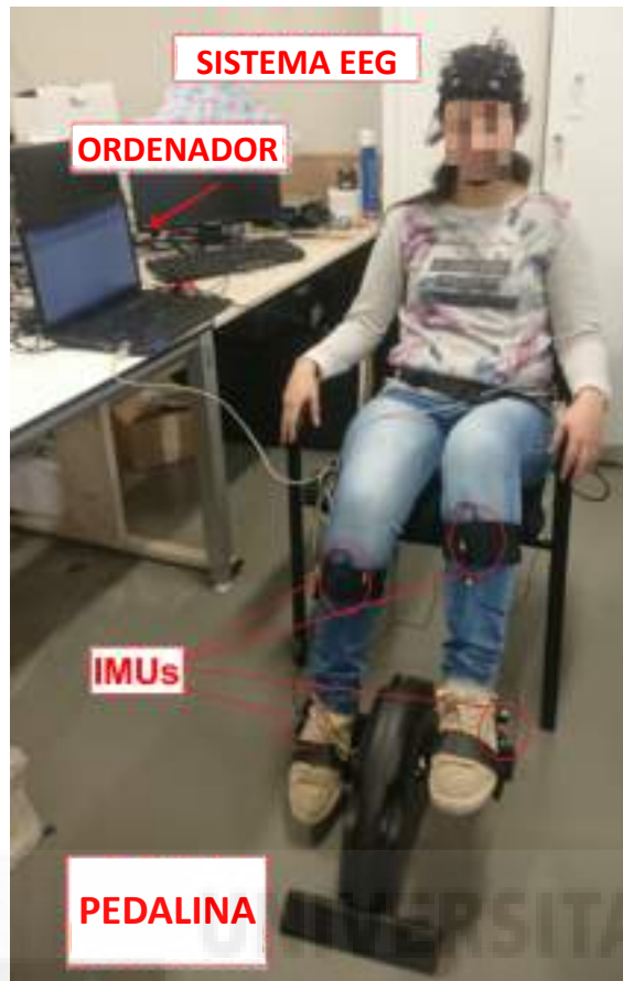
Figura 3.1: Arquitectura del sistema. El sistema de EEG graba las señales encefalográficas del usuario y el sistema de captura de medidas inerciales (IMUs por sus siglas en inglés) adquiere los datos del sujeto mientras pedalea. El ordenador recibe de manera síncrona los datos de las IMUs y el sistema EEG.
