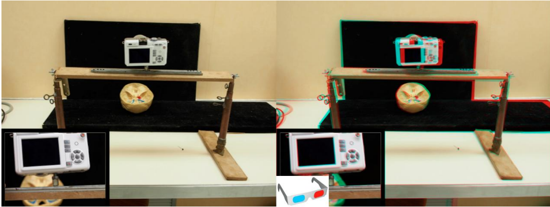
FIG 17. Barra de deslizamiento horizontal de propia manufactura para cámara fotográfica. Permite ajustar la cámara de fotos y realizar deslizamientos sobre un plano horizontal de una forma controlada.
