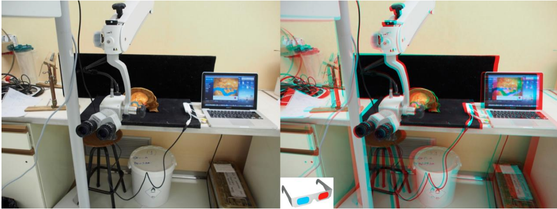
FIG 25. Método de captura de imágenes mediante el uso de microscopio convencional 2D. Esta imagen corresponde a la adquisición de la primera fotografía correspondiente al ojo izquierdo.
