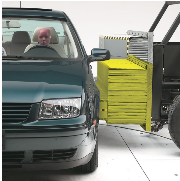
Figura 2.21 Barrera deformable NHTSA, en amarillo, superpuesta a la barrera MDB IIHS.
