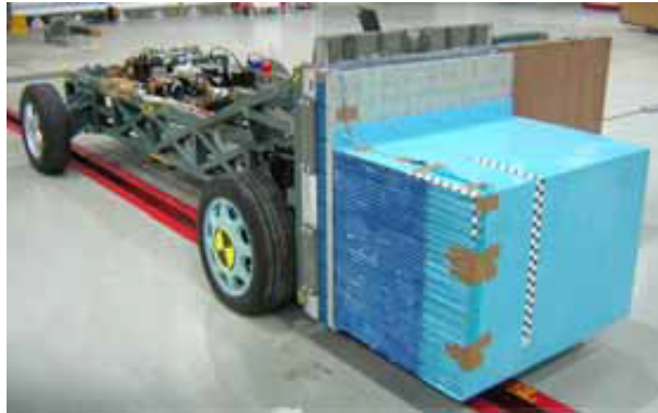
Figura 2.6 Propuesta de Takizawa de barrera deformable móvil para impacto frontal con solapamiento parcial
