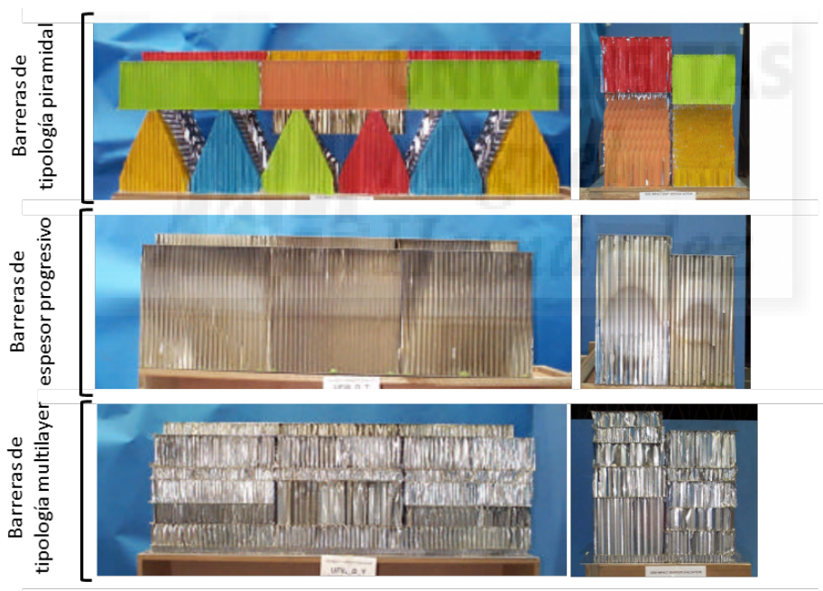
Figura 2.13 Distintos diseños de MDB que cumplen con el ensayo de certificación según la Directiva 96/27/EC [128].
