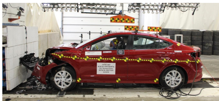
Figura 4.2 Imagen Post-test de un Hyundai Elantra en la configuración de impacto utilizada [NHTSA Test N° 9793].
