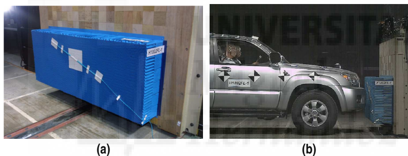
Figura 2.2 Vistas de la Full Width Deformable Barrier (FWDB).
