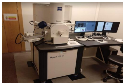
Ilustración 9. Microscopio electrónico de barrido de campo, Modelo SIGMA 300 VP de ZEISS.
