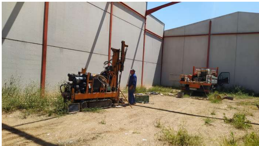
Máquina de sondeos realizando trabajos de campo. Emplazamiento Penetración 2.
