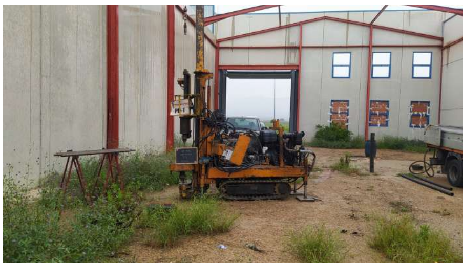
Máquina de sondeos realizando trabajos de campo. Emplazamiento Penetración 1.
