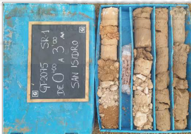
Imagen 3. Caja portatestigos con las muestras recuperadas en el sondeo
