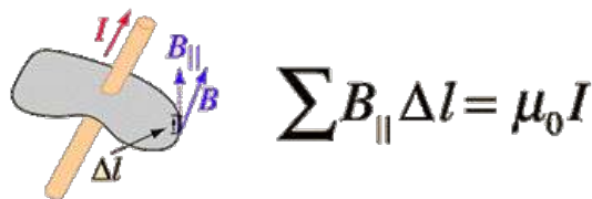
Figura 1.6: Una corriente eléctrica produce un campo magnético
