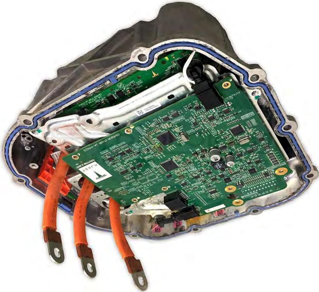
Figura 1.25: Inversor DC-AC del Tesla Modelo S
