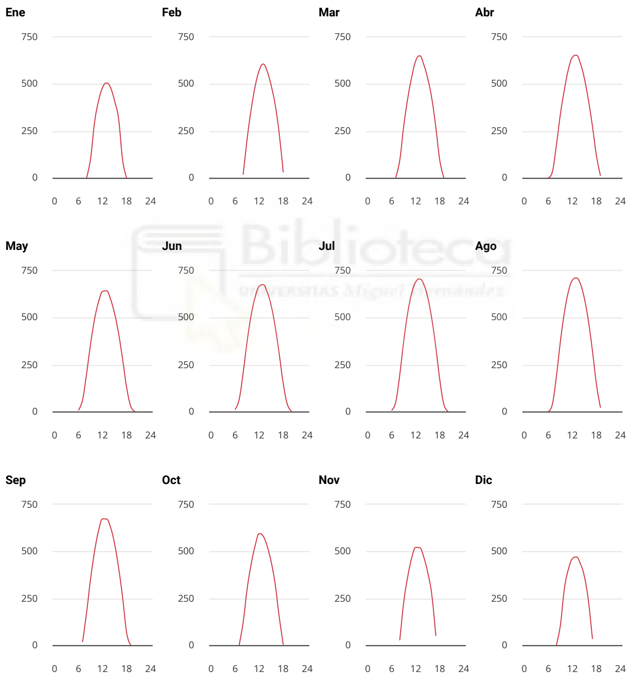
Figura 6.1: Producción eléctrica fotovoltaica específica – promedios horarios
