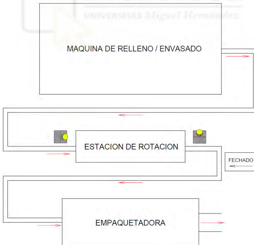
Figura 1-6. Esquema simplificado del proceso global de la línea de envasado.
