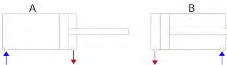
Figura 1-12. Principio de funcionamiento de un cilindro neumático de doble efecto. En azul es la entrada de flujo de aire.
