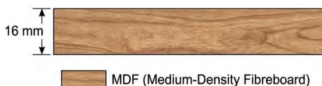
Ilustración 8 - Sección tablero MDF 16 mm
