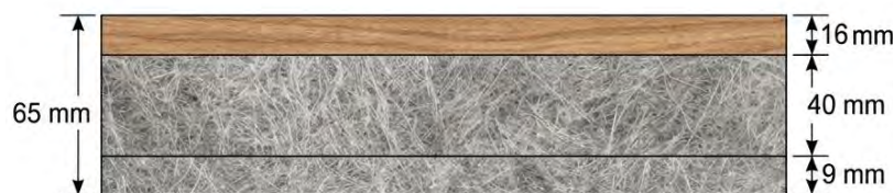
Ilustración 10 - Sección MDF 16 mm + PET 40 mm + PET 9 mm
