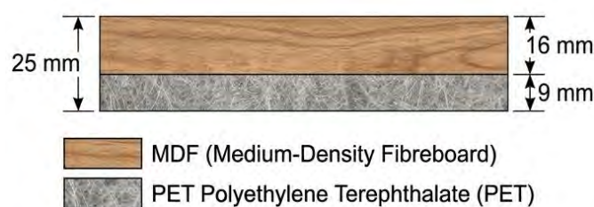
Ilustración 9 - Sección MDF 16 mm + PET 9 mm
