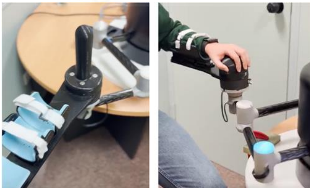
Figura 7: Primera versión del efector final, en forma de cilindro y esfera.
