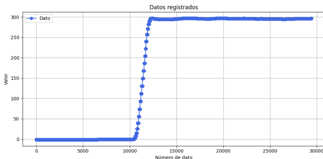
Figura 42: Representación gráfica de la medida de calibración obtenida con la pesa de 1950g.
