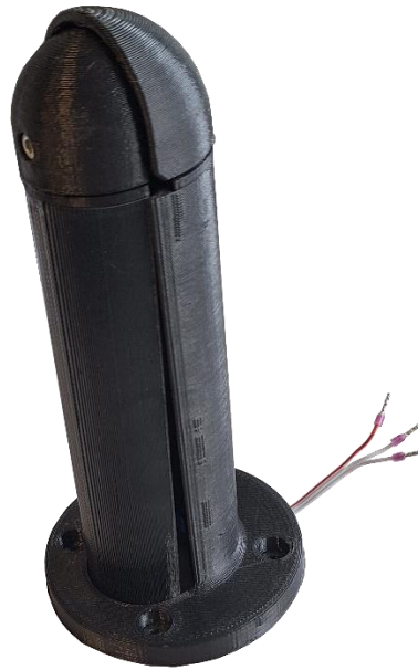
Figura 8: Segunda versión del efector final, gatillo con final de carrera.
