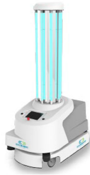
Figura 1.13: Robot móvil UVD de desinfección sanitaria. Fuente: [21]
