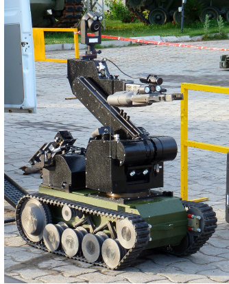
Figura 1.9: Robot desactivador de explosivos tEODor. Fuente: [15]
