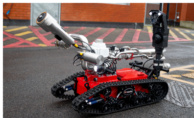
Figura 1.12: Robot bombero para tareas de rescate. Fuente: [19]
