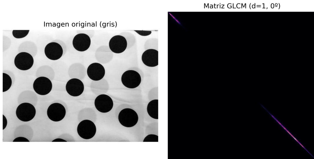
Figura 2.5: Visualización de una Matriz de Coocurrencia (GLCM). A la izquierda, la imagen original. A la derecha, la representación gráfica de la GLCM calculada para d = 1 y \theta = 0^\circ . La fuerte concentración de valores en la diagonal principal indica que la mayoría de los píxeles vecinos tienen intensidades idénticas o muy similares (alta homogeneidad), correspondiendo a las áreas uniformes de los círculos y el fondo, mientras que los valores fuera de la diagonal representan los bordes (transiciones de contraste).
