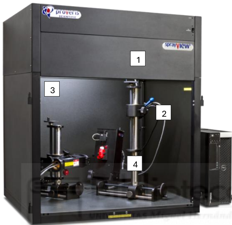
Figura 6. Equipo Proveris SprayVIEW. La figura muestra el sistema utilizado para el análisis del aerosol. Cada número indica un componente específico del equipo, identificado para facilitar la comprensión de su función y el detalle del montaje experimental.
