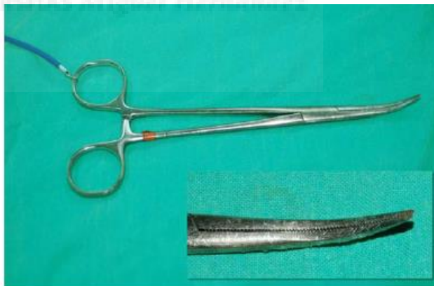
Figura 25. Prototipo de pinza de disección estimulante. El alambre estimulante se conecta al mango de unas pinzas de disección convencionales; las hojas de disección se aislaron con una membrana transparente [Tegaderm™ Film, 3M Health Care, Neuss, Alemania] y solo se expusieron puntas de 1 mm de las pinzas. Tomada de: Schneider R, Randolph GW, Dionigi G, Wu C, Barczynski M, Chiang F, et al. International neural monitoring study group guideline 2018 part I: Staging bilateral thyroid surgery with monitoring loss of signal. The Laryngoscope [Internet]. octubre de 2018 [citado 29 de septiembre de 2023];128(S3).
