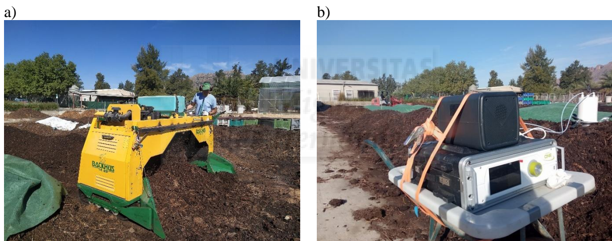
Figura 6. a) Aireación por volteo de una pila de compostaje. b) Sistema de medición de gases de efecto invernadero en campo aplicado a pilas de compostaje. Fuente: elaboración propia.
