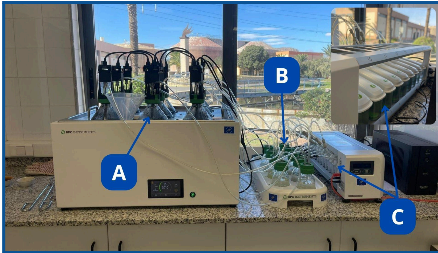
Figura 4. Vista general del sistema AMPTS III Light. (A): Biorreactores de digestión anaerobia. (B): Botellas eliminadoras de CO 2 . (C): Válvulas de cuantificación de CH 4 .
