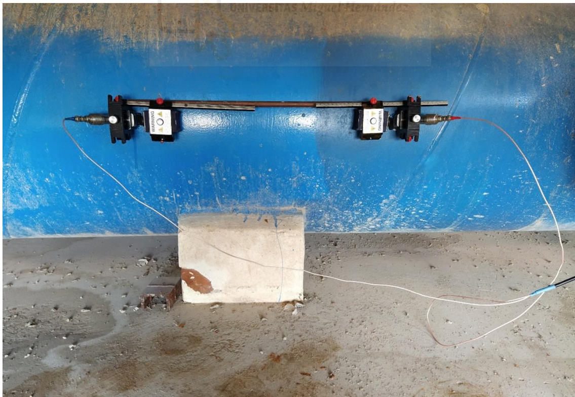
Vista del caudalímetro ultrasónico listo para medir.
