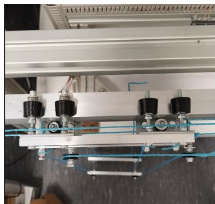
Figura 53. Disposición de las ruedas horizontales en el carro portador.
