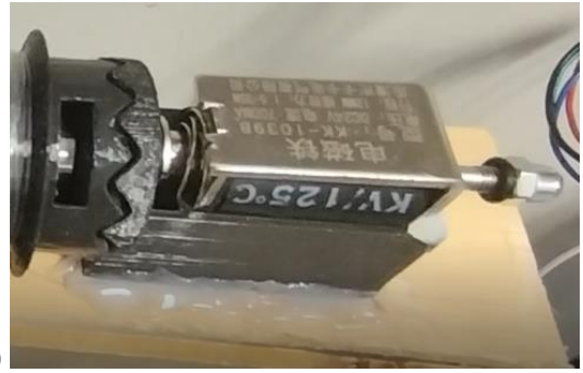
Figura 45. Posiciones del actuador: a) Actuador no alimentado. Muelle extendido con el tambor en su posición natural, b) Actuador alimentado. Muelle comprimido con el tambor desplazado.
