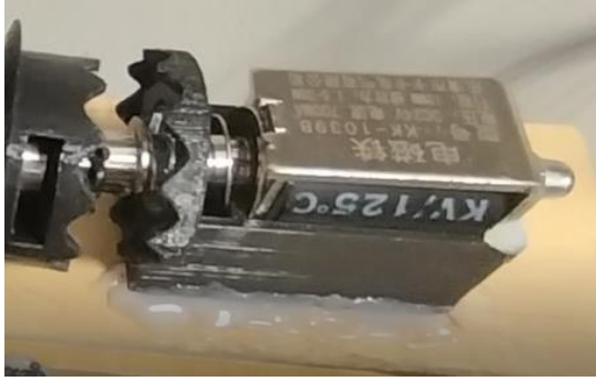
Figura 45. Posiciones del actuador: a) Actuador no alimentado. Muelle extendido con el tambor en su posición natural, b) Actuador alimentado. Muelle comprimido con el tambor desplazado.
