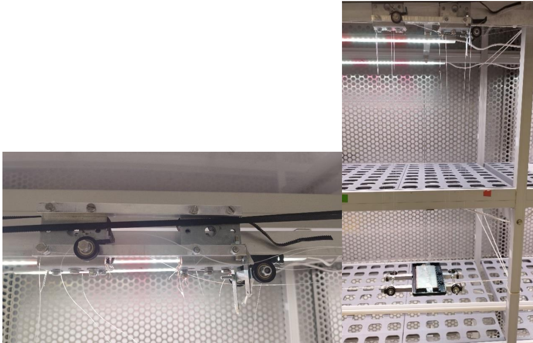
Figura 89. Vista del sistema de hilos y poleas: a) En el carro portador, b) Plataforma pendida sobre los hilos que bajan del carro portador.
