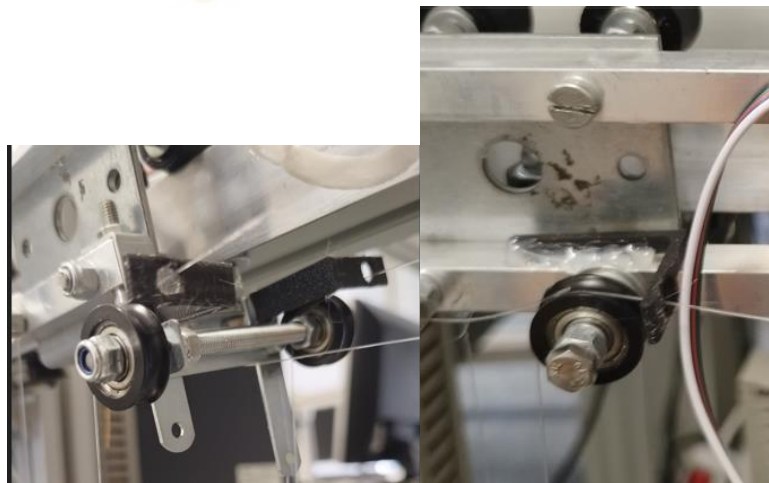
Figura 55. Vistas de las guías del carro portador ubicadas antes de las poleas.
