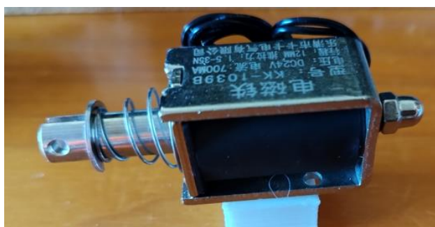
Figura 20. Actuador lineal 1039B, 1.5-35N, 12mm, 24V.
