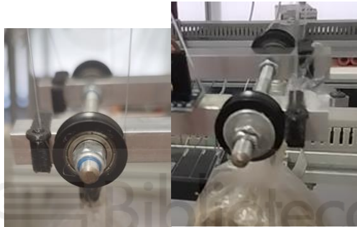
Figura 56. Guías de la plataforma junto a las poleas.
