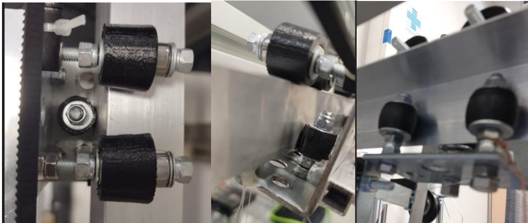
Figura 52. Disposición de las diferentes ruedas del carro portador alrededor de la viga principal.
