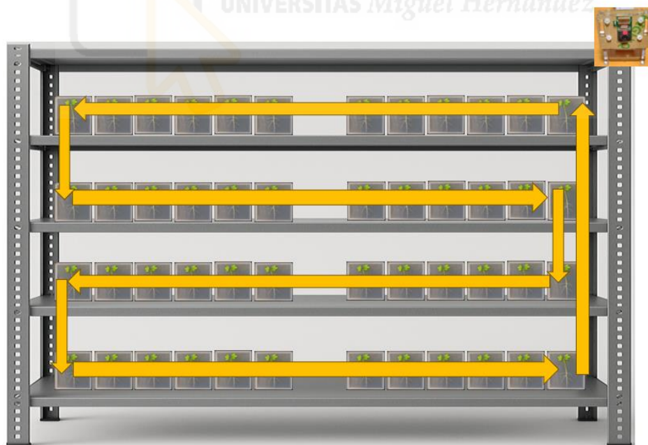
Figura 58. Recorrido de la plataforma a través de las placas durante el funcionamiento.
