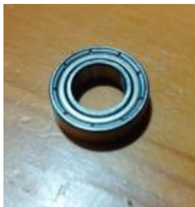
Figura 16. Vista de un rodamiento.
