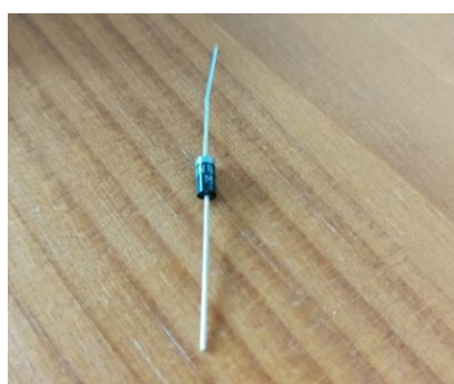
Figura 22. Diodo rectificador 1n4007.
