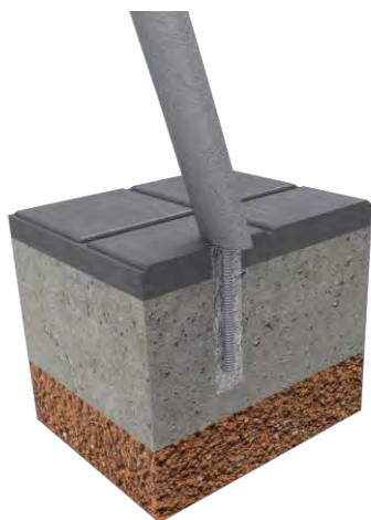
Figura 23. Anclaje del banco.
