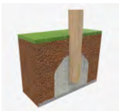
Figura 32. Anclajes del muelle.
