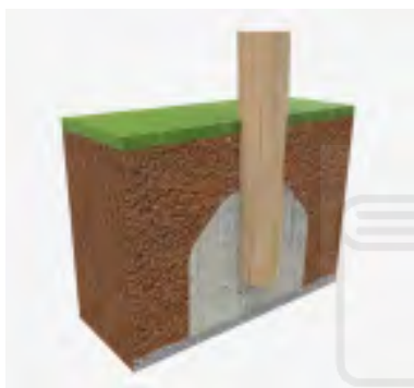
Figura 35. Anclajes del tobogán.
