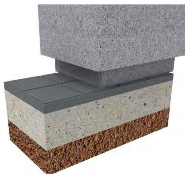
Figura 27. Anclaje de la papelera.
