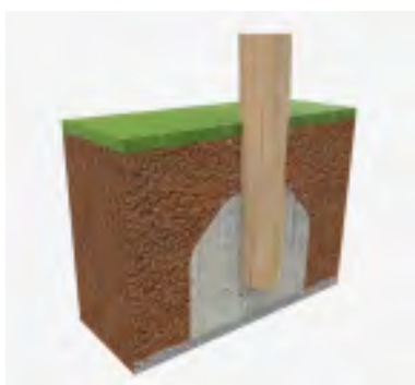
Figura 38. Anclajes del tobogán.
