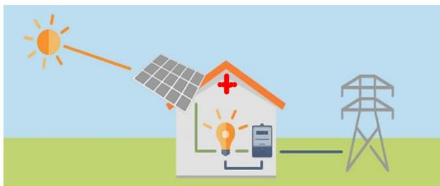
Ilustración 18. Instalación de autoconsumo.
