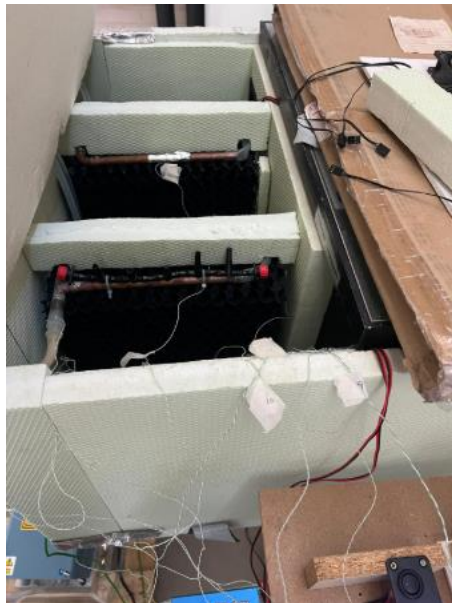
Figura 62. Termopares conectados en el interior del equipo
