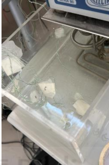
Figura 70. Vista de los 10 termopares introducidos dentro de un baño termo regulable
