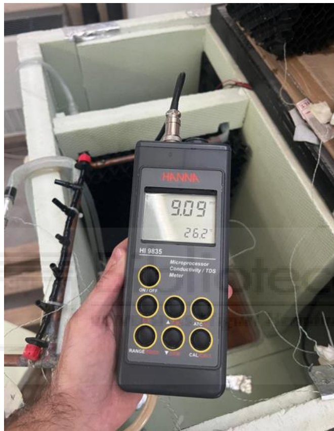
Figura 96. Medición de la conductividad del agua del depósito del evaporador
