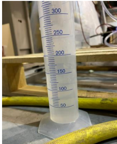
Figura 59. Probeta graduada para la medición del caudal de condensados
