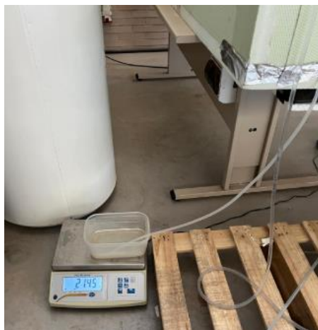
Figura 60. Báscula digital para la medición del caudal de condensados
