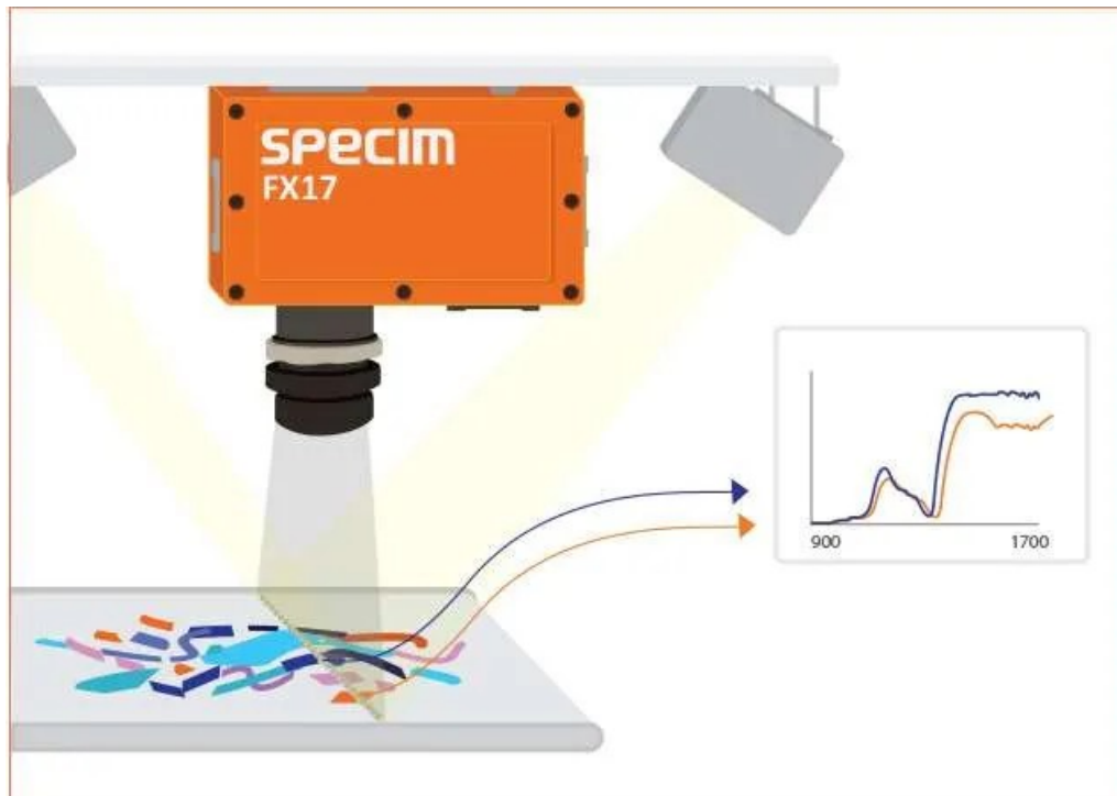
Figura 2.2: Ejemplo de sistema industrial de clasificación basado en imagen hiperespectral (HSI) aplicado al reciclado de materiales, integrado sobre una línea automatizada.
