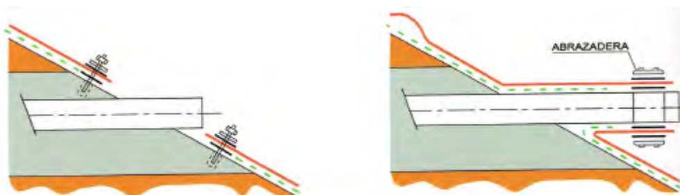
Figura 24. Unión de la geomembrana con la tubería de entrada de agua
