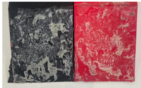
Figura 38. Supertec 6200 (Unión envejecida)
