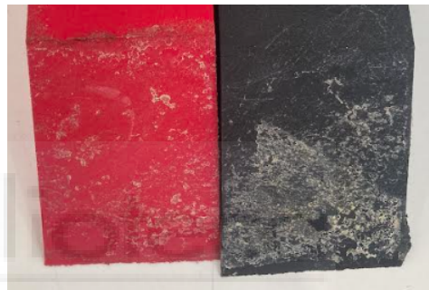
Figura 36. H. B. Fuller Swift Col 9720 (Unión envejecida)
