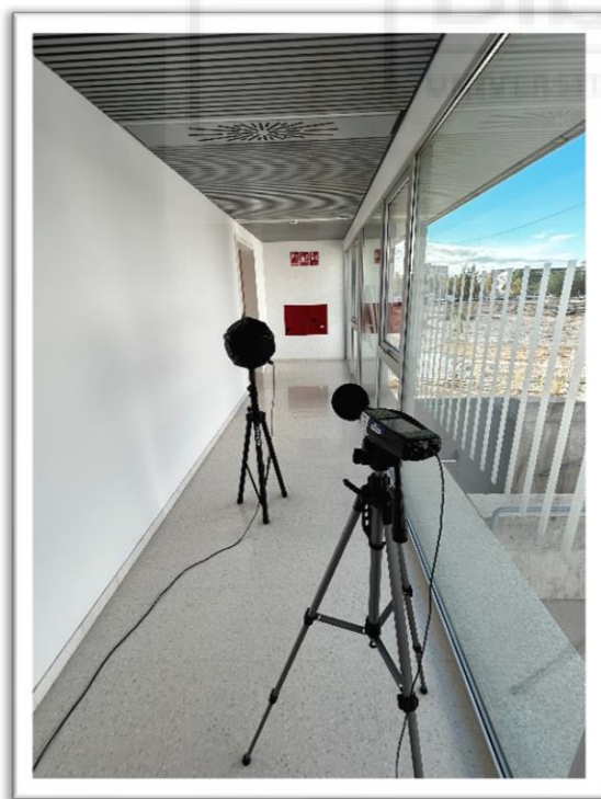
Figura 67: Disposición de la fuente y el sonómetro en el pasillo junto el Laboratorio IME 5 grande.
