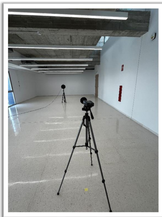
Figura 69: Disposición de la fuente y el sonómetro en el Laboratorio IME 5 grande.
