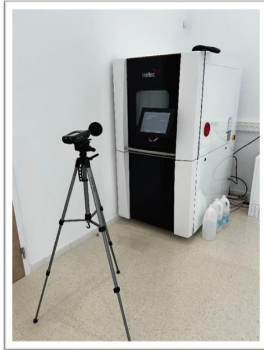
Figura 53: Disposición del sonómetro frente a la Máquina 1 en el Laboratorio IME 1.
