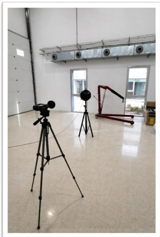
Figura 48: Disposición de la fuente y el sonómetro en el Laboratorio IME 1.
