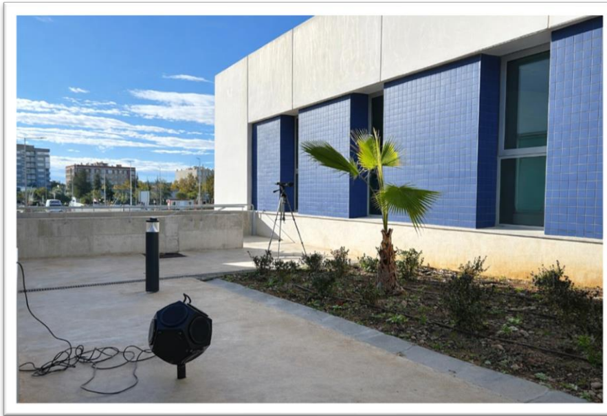
Figura 70: Disposición de la fuente y el sonómetro en el patio exterior del edificio frente a fachada colindante al Laboratorio IME 5 grande.
