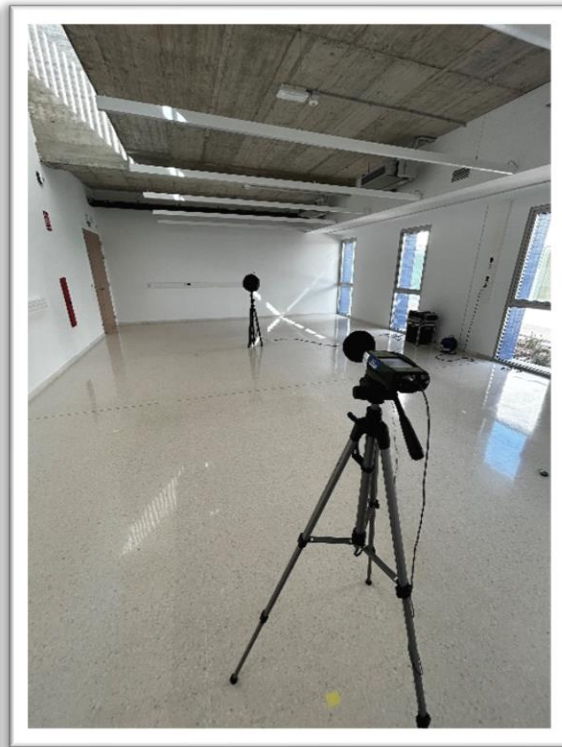
Figura 68: Disposición de la fuente y el sonómetro en el Laboratorio IME 5 pequeño.
