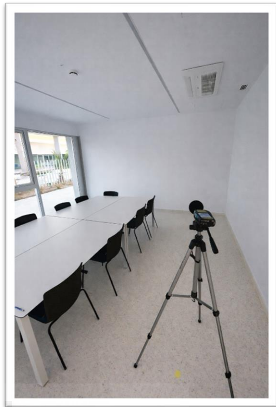
Figura 78: Detalle de la posición del sonómetro en la Sala I+D.
