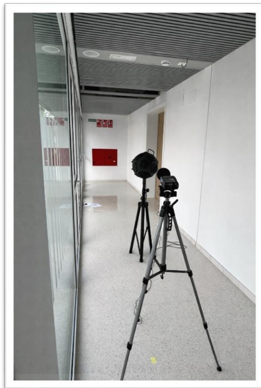
Figura 47: Disposición de la fuente y el sonómetro en el pasillo junto a Laboratorio IME 1.
