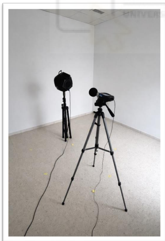
Figura 45: Disposición de la fuente y el sonómetro en la sala pequeña junto a Laboratorio IME 1.
