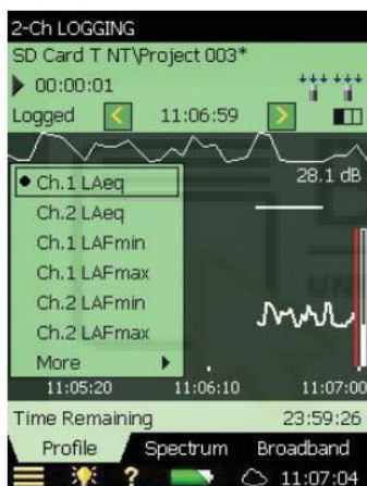
Fig. 10 Pantalla de registro de 2 canales
