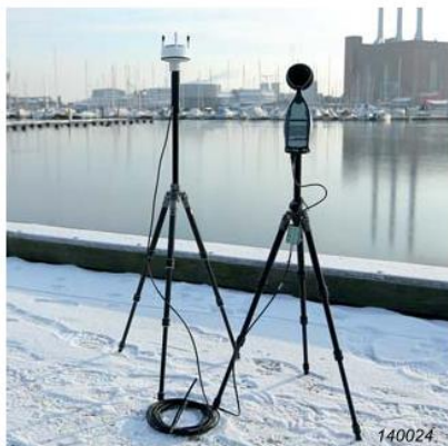
Fig. 15 Utilización del analizador portátil para medir el ruido exterior con un kit de estación meteorológica
