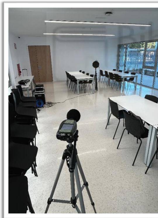
Figura 77: Disposición de la fuente y sonómetro en la Sala común.
