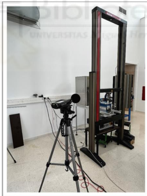
Figura 54: Disposición del sonómetro frente a la Máquina 2 en el Laboratorio IME 1.
