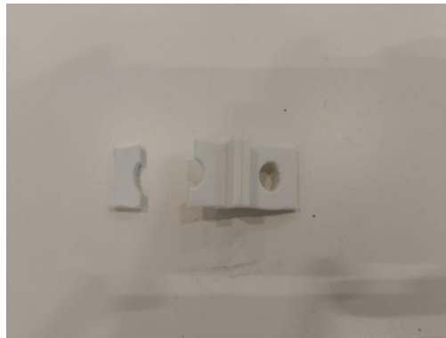
Figura 37. Probeta que ha sufrido una rotura.
