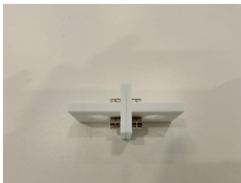
Figura 26. Preparación para el tratamiento térmico con los imanes.
