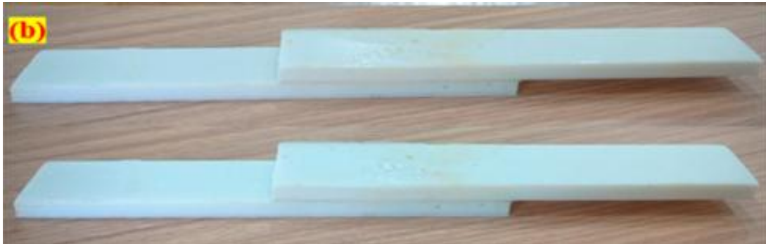
Figura 4. Probetas antes de ensayarse unidas mediante resina epoxi [14].
