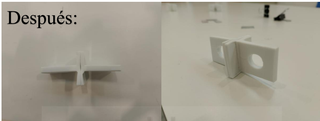
Figura 31. Antes y después del tratamiento térmico con las pinzas.
