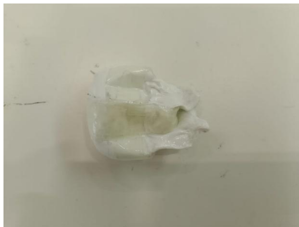
Figura 41. Esfera sometida a 180 °C dentro del horno.
