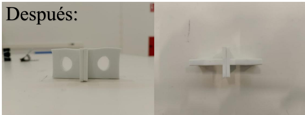
Figura 32. Antes y después del tratamiento térmico con la cinta adhesiva.
