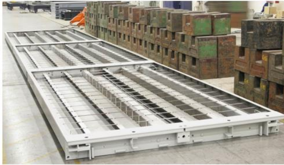
Figura 9. Báscula de pesaje de camiones C&C
