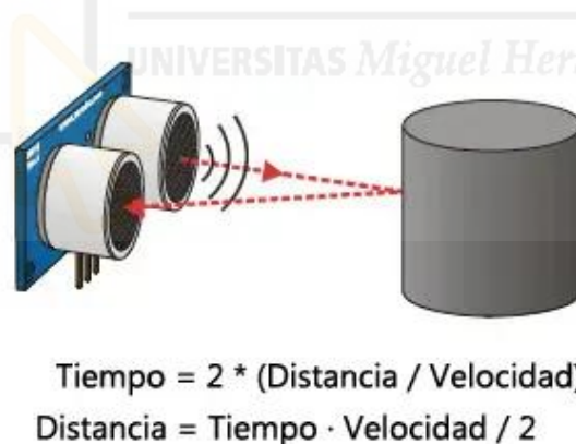
Figura 4: Principio de funcionamiento basado en el tiempo de vuelo (time-of-flight) y cálculo de la distancia.
