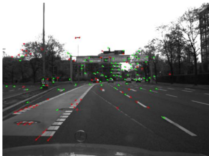
Figura 5: Ejemplo de seguimiento de características (feature tracking) en un entorno de conducción real (Dataset KITTI).
