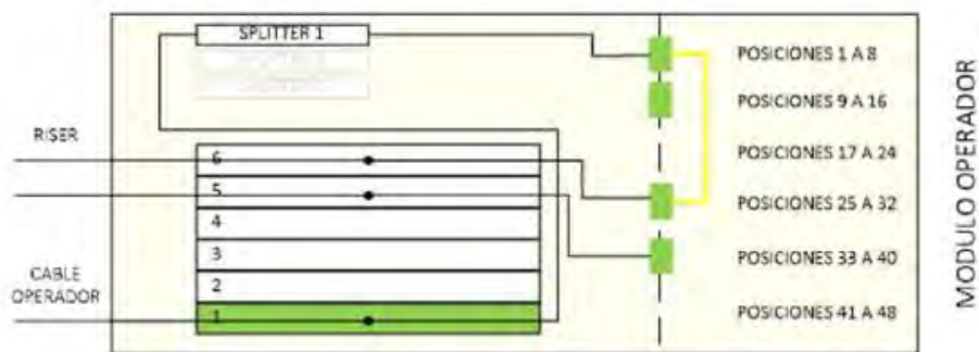
Figura 37. Conexión CTO interior 48P escenario de 16 a 24 UUUI. [10]
