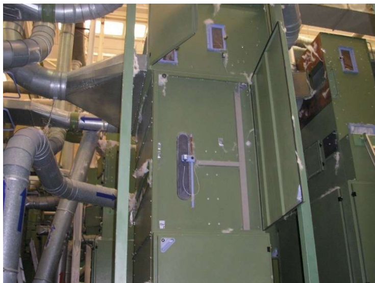
Figura 10: Maquinaria y tubos de transporte de fibra
