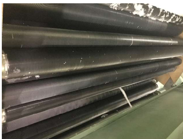
Figura 11: Rodamientos vestidos de púas de cardas
