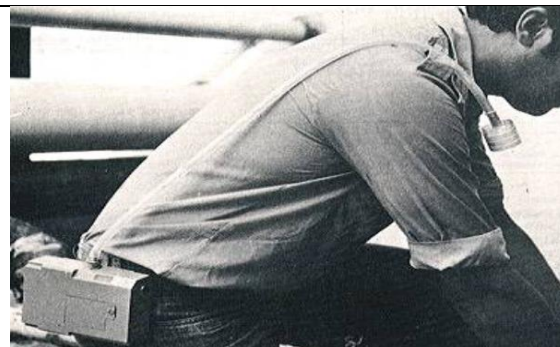
Figura 19. Tubo de muestreo en la solapa y bomba de muestreo sujeta en el cinturón.
