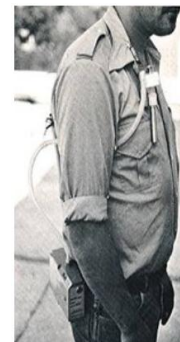
Figura 11. Tubo de muestreo en la solapa y bomba de muestreo sujeta en el cinturón.
