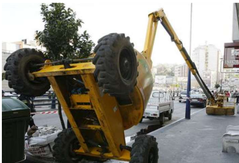
Figura 33 Vuelco de PEMP por mal uso
