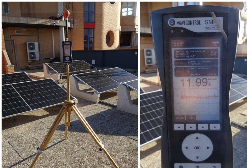
Figura 23 Sonda para mediciones radioeléctricas
