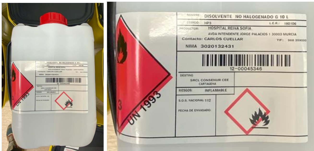
Figura 5. Recipiente para recogida de disolvente no halogenado. En el etiquetado se puede observar los pictogramas de riesgo según la normativa CLP asociados a la característica de peligrosidad HP3 (inflamable). También aparece el código LER correspondiente 180106.
