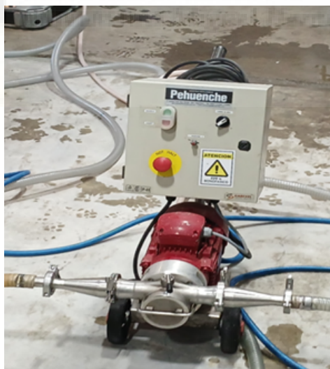
Figura 6 Bomba de rotor flexible con conexión tipo clamp Fuente: Elaboración propia. Fotografía tomada en Bodega Nativa.
