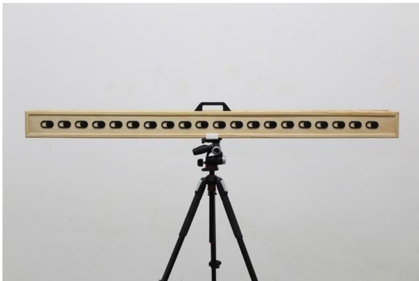
Imagen 6. Cámara estenopeica de veinte estenopos. Madera, PLA y metal. 160 x 15 x 15 cm (Fuente: elaboración propia)
