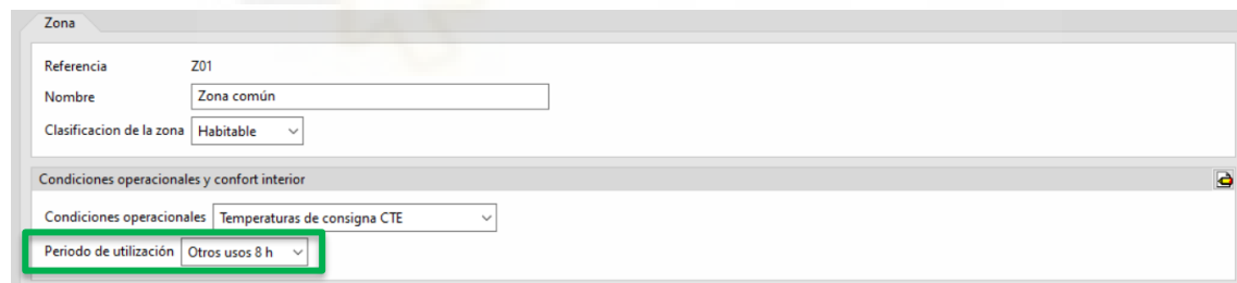
Figura 41. Cambio periodo de utilización en zona en CYPETHERM HE Plus (Fuente: Elaboración propia)
