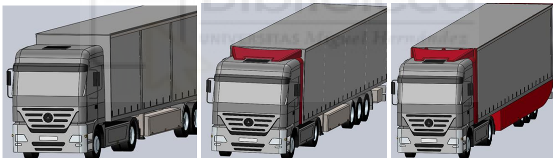
FIGURAS 1.15, 1.16 y 1.17 CAMIÓN SIN DEFLECTORES, CON DEFLECTORES BASICOS Y DEFLECTORES TOTALES RESPECTIVAMENTE [21]
