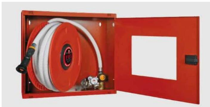
El criterio de diseño se hará en base al número suficiente de BIEs para que con la longitud de la manguera de 20 m. el alcance estimado en 5 m., permita alcanzar todo punto de la zona a proteger.
