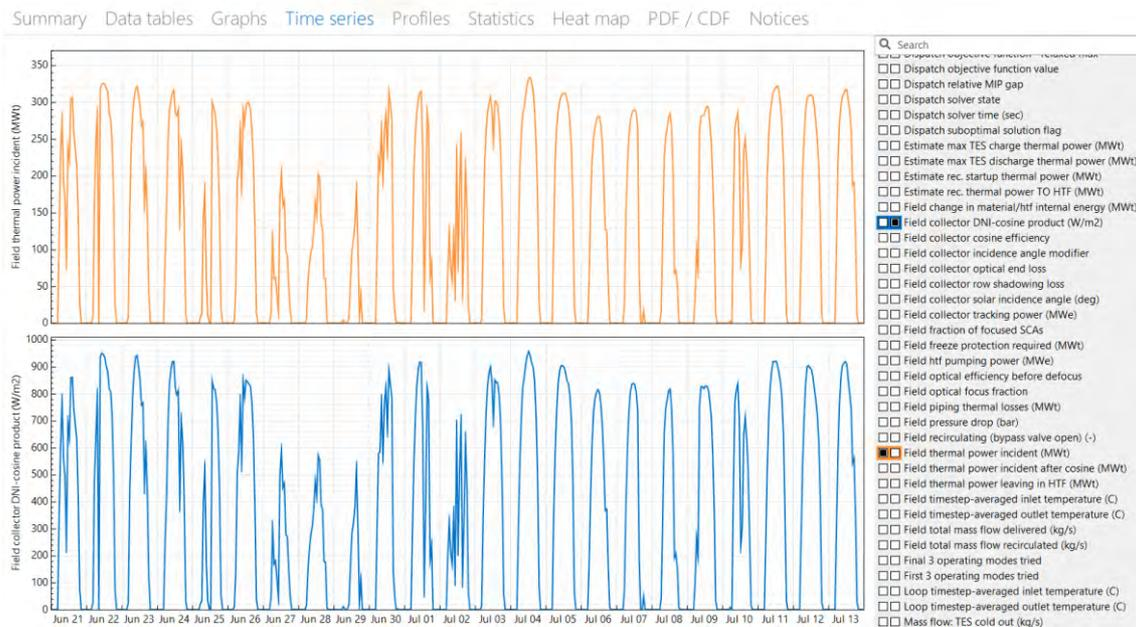
Figura 54. Resultados horarios de potencia térmica incidente e irradiancia en el plano del colector para el caso base. Ampliado para los días entre el 21 de junio y 13 de julio.
