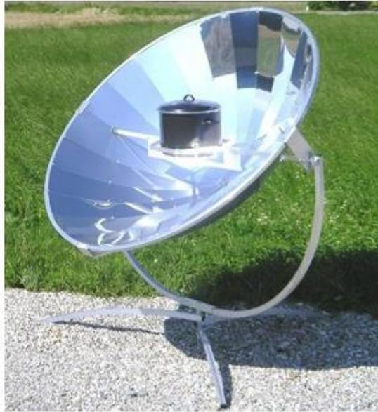
Figura 27. Diseño de cocina solar.
