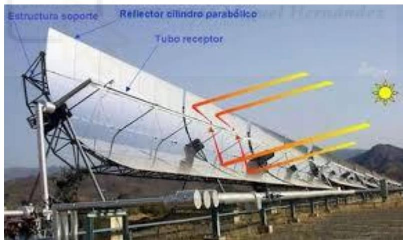
Figura 30. Canales Cilindro Parabólicos.
