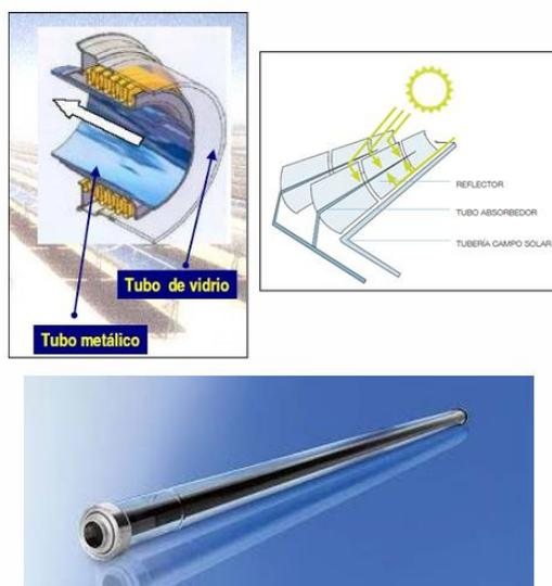
Figura 31. Tubo Receptor.
